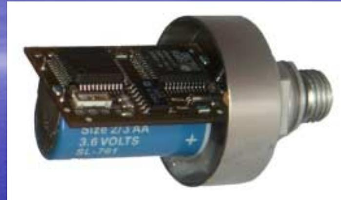
Principe de fonctionnement d'un ordinateur type Monitor 3, Aladin Air X ou Aladin Air Z avec capteur de pression.
