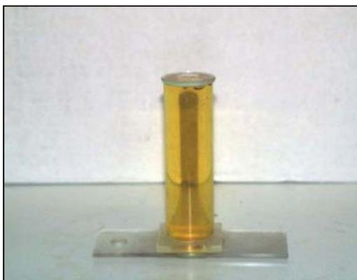
**Photo 2** Chambre de sédimentation (Photo A. Rolland)
