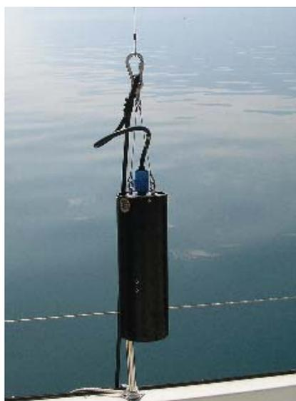
**Photo 1** La sonde spectrofluorimétrique prête à l'emploi
