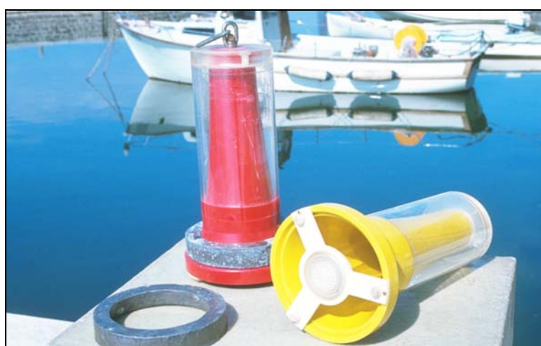
Photo 1 Appareil intégrateur collecteur du phytoplancton
