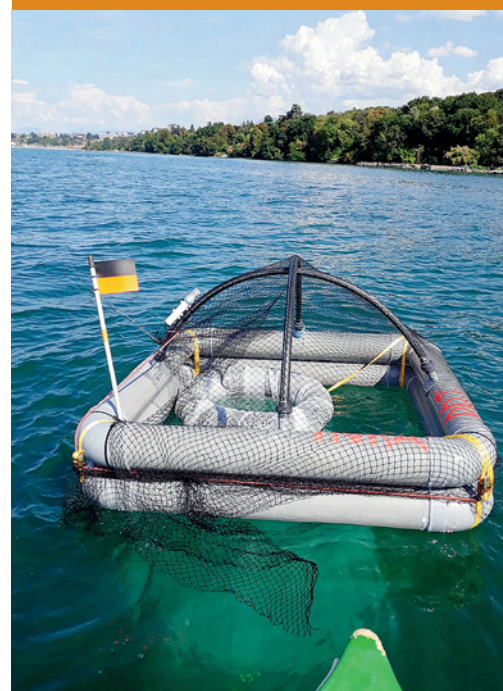
Le sac rempli d'eau, lesté et rattaché à la structure flottante, est visible sur cette photo
