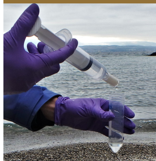
Filtration d'eau sur le terrain permettant de récupérer de l'ADN environnemental
