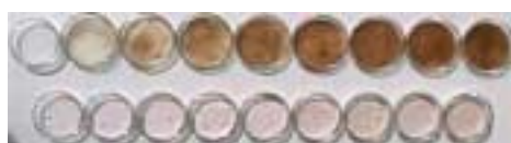
Figure 3.10 : Pyrène sur silice (haut) et Pyrène sur calcite (bas) de t = 0 à 240 min de gauche à droite.
